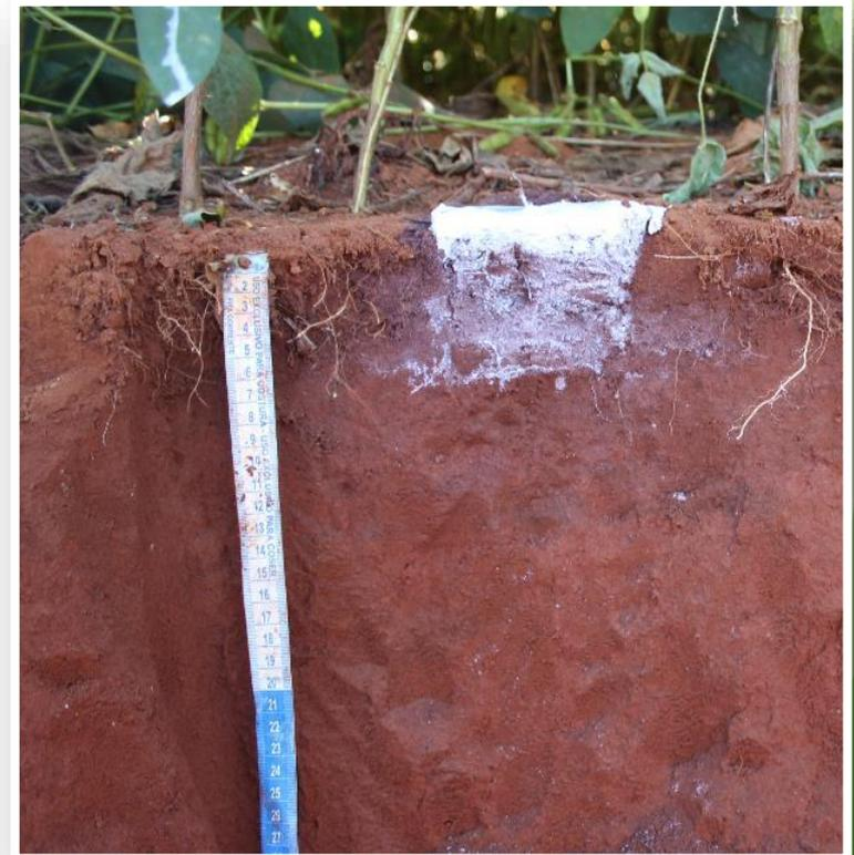
Aplicação de água raz com tinta branca para marcar o fluxo de movimento da água no solo. O solo da foto apresentou um leve acúmulo de água na camada de 20 cm de profundidade, evidenciado pela abertura da mancha de tinta, com posteriormente percolação normal da água. (Shiozaki, E; Sakai, P; Sako, H. – CESB, 2017)
