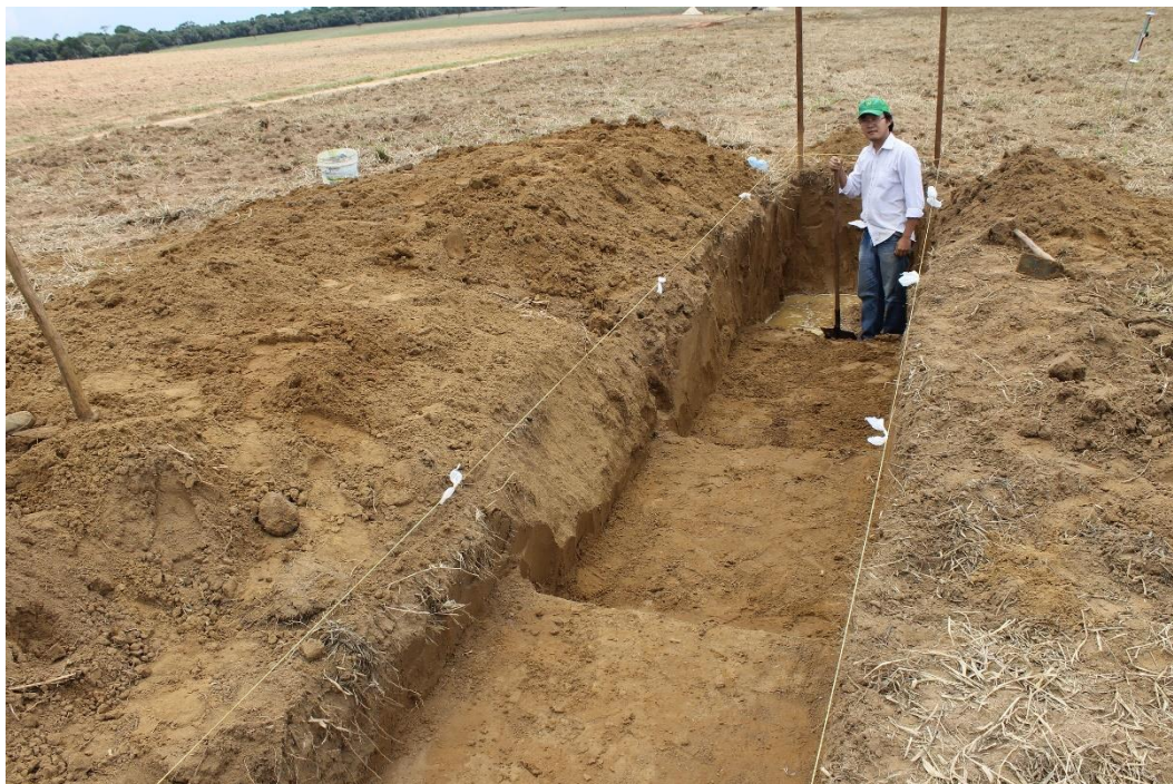
Figura 6. Abertura de trincheira em diferentes profundidades.
